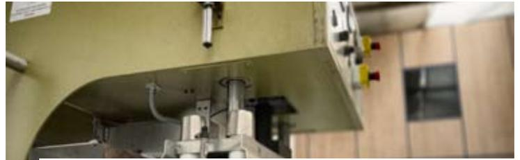
**4.** Al mismo tiempo en nuestro taller textil se procede a la fabricación de lonas mediante soldadura de alta frecuencia.
