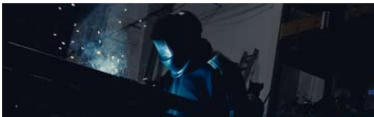
**3.** Para la fabricación de los nudos de unión, se sueldan piezas realizadas en acero de alta tenacidad cortado mediante laser.
